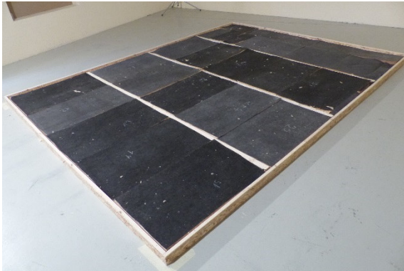
Bild 1: Aufbau Rahmenkonstruktion mit Bedämpfung
