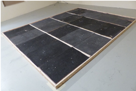
Bild 1: Aufbau Rahmenkonstruktion mit Bedämpfung
